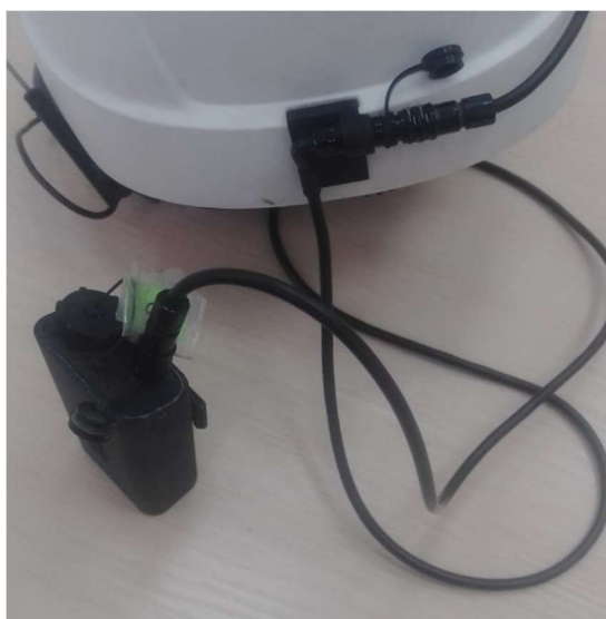
Рисунок 9. Применение удлинителя для батарейного блока.
