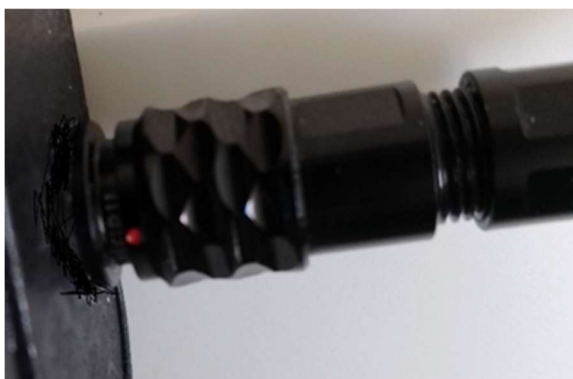
Рисунок 8 – Соединение гарнитуры с батарейным блоком
