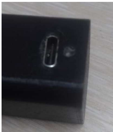
Рисунок 30, Разъем зарядки и светодиод статуса зарядки.
