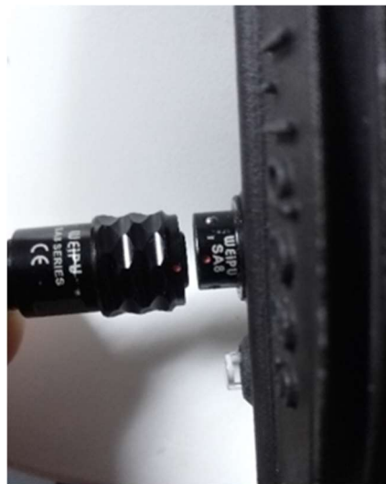
Рисунок 8 – Соединение центрального блока и гарнитуры
