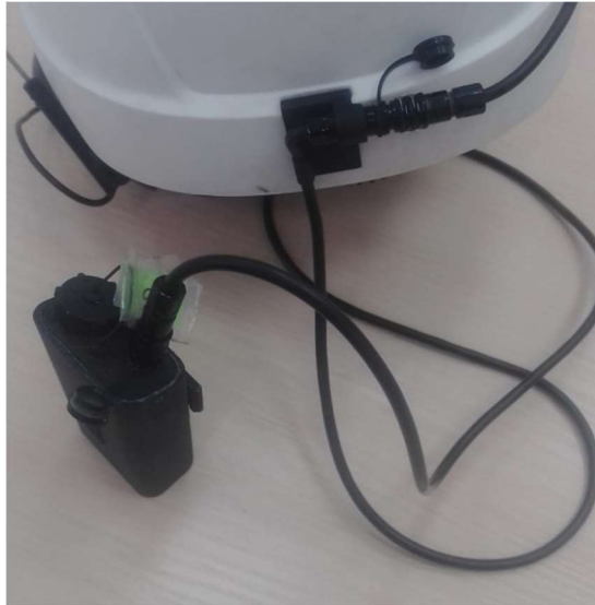
Рисунок 10. Применение удлинителя для батарейного блока.
